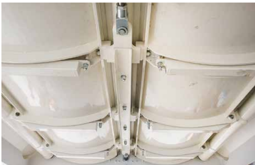
De bodemkleppen met stevige vergrendeling zorgen voor een snelle lossing van het mengsel.
