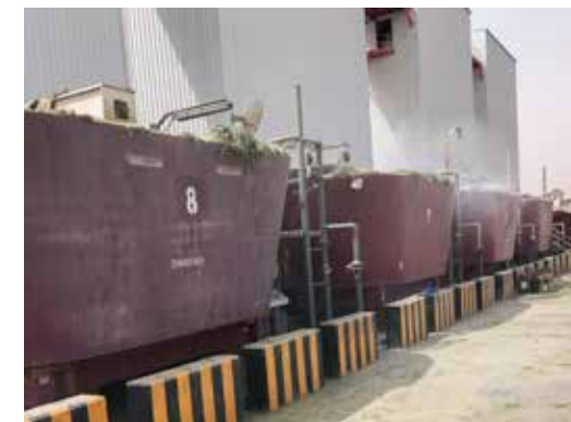
Onder de 16 silo's bevinden zich schroeven die de voermengers voorzien van het juiste recept
