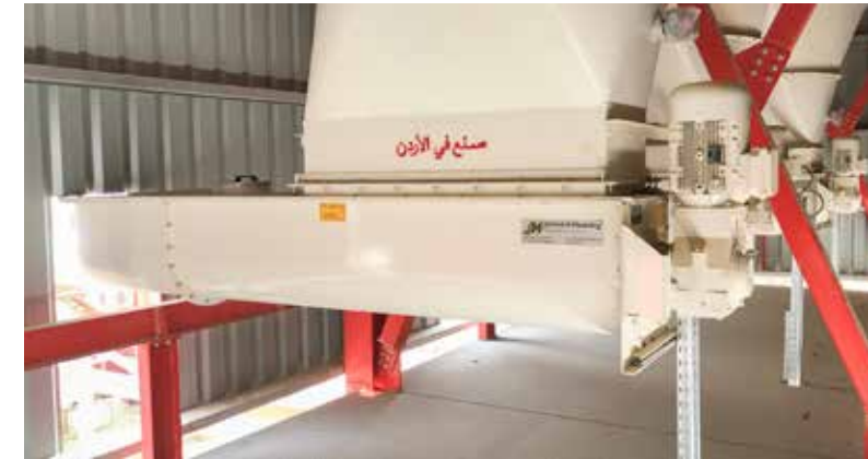
Onder de 16 silo's bevinden zich schroeven die de voermengers voorzien van het juiste recept
