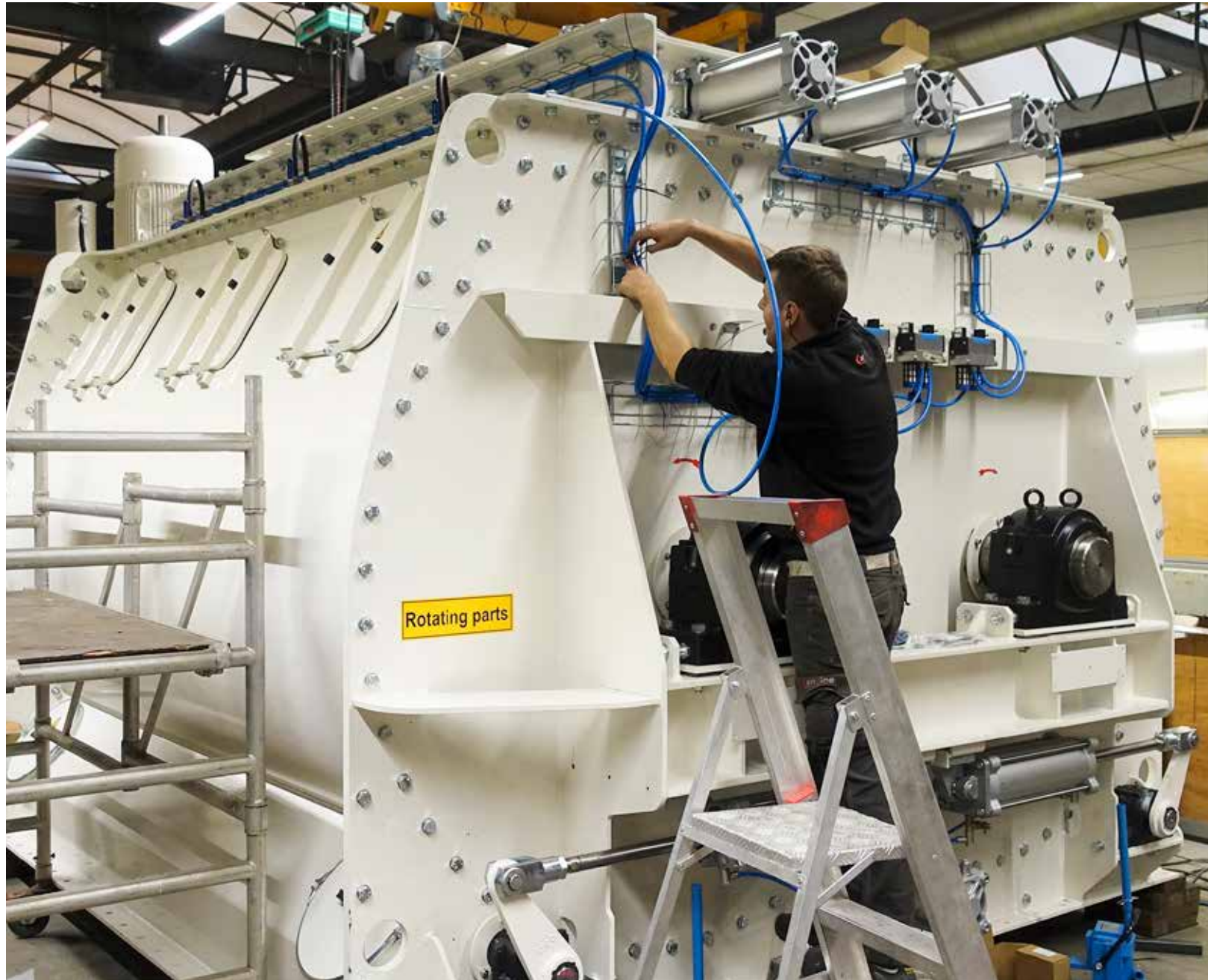
De twee mixers van elk 10m 3 werkinhoud worden in de fabriek van Jansen&Heuning geassembleerd en getest.
