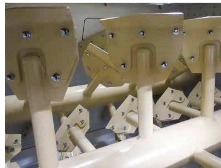
Paddelmixers zijn zeer effectief en snel doordat de twee mengarmen in elkaars baan werken.
